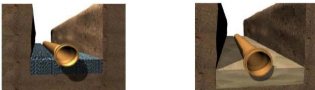
Para as valas localizadas no leito carroçável da rua, devem ser cumpridas a condição de distância mínima entre as tubulações de água e de esgoto de 1,00m. O escoramento deve ser feito conforme indicado nas normas ABNT NBR 12266:92 e NBR 9061:85.
